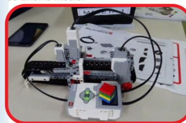
Robótica - Os alunos dos 9ºs anos construíram uma esteira seletora a partir de uma esteira transportadora utilizando um sensor de cor e uma alavanca separadora, programaram o sensor de cor e movimento da alavanca separadora para que a esteira transportadora funcionasse como esteira seletora.
